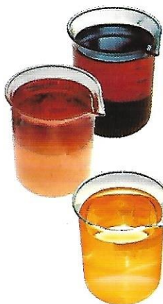
Muestra de gasoil contaminado con azufre, parafina, sílice, óxido, microorganismos y agua emulsionada.
